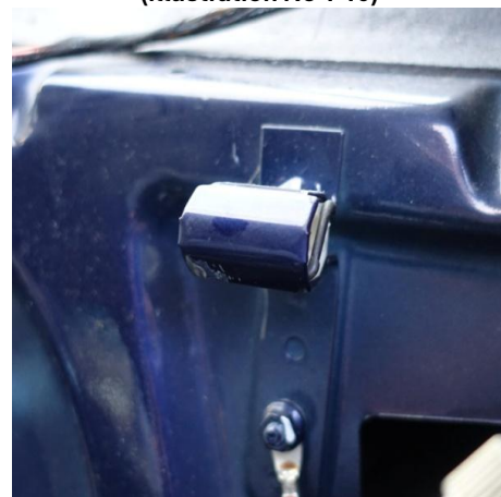
Ilustracja 2: Mocowanie tylniej kanapy Illustration 2: Mounting of the rear seats
