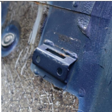
Ilustracja 3: Mocowanie tylnej kanapy Illustration 3: Mounting of the rear seats
