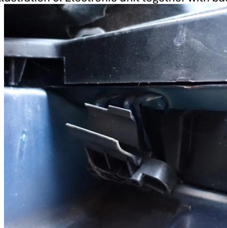
Ilustracja 8: Mocowanie lewarka zmiany koła zapasowego Illustration 8: Attachment of the lift for spare wheel changing
