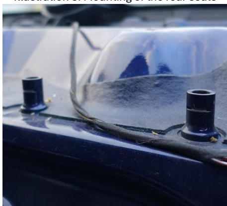
Ilustracja 5: Mocowanie zagłówka Illustration 5: Attaching the headrest
