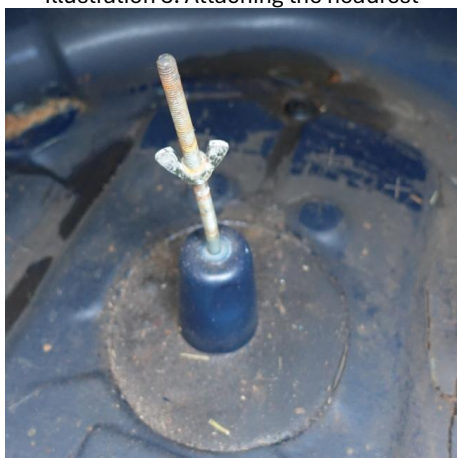
Ilustracja 7: Mocowanie koła zapasowego wraz z podstawą Illustration 7: Attaching the spare wheel together with the basis
