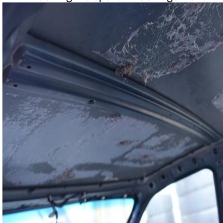
Ilustracja 9: Belka wzmacniająca dach Illustration 9: Roof reinforcement strut
