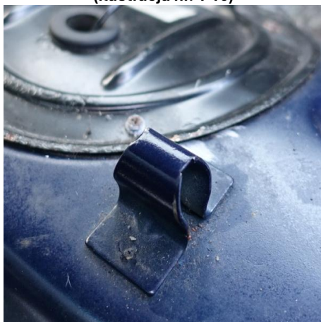
Ilustracja 1: Mocowanie tylniej kanapy Illustration 1: Mounting of the rear seats
