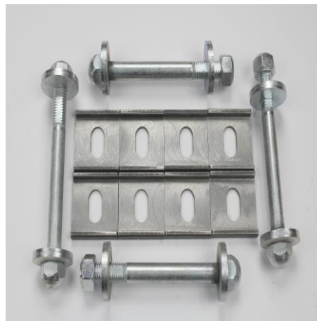
Ilustracja 12: Zestaw elementów do modernizacji tylnej belki E36 compact.
